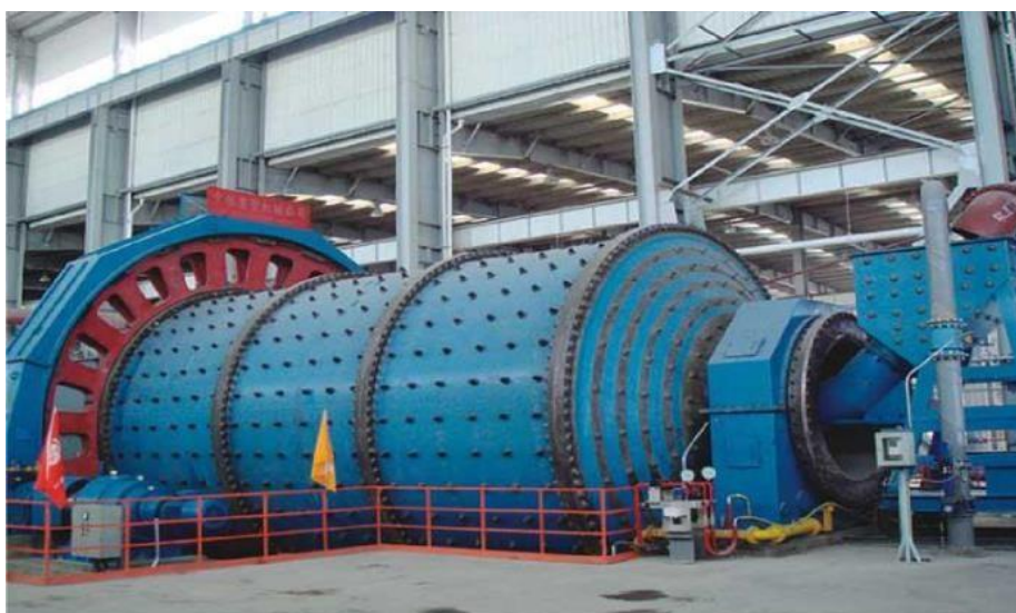
8 Сурет – Шар диірмені Ø 6,2×9,5 м, 2 дана, 6000 кВт
